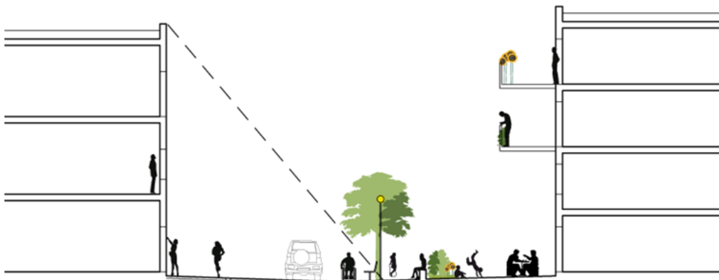
Figur 5.19: Snitt av Heivei. Solvinkel kl. 13 ved sommersolverv er vist som stiplet linje. På for- og ettermiddag vil solforholdene i Heivei være svært gode. Høyden på bygg på sydsiden i Heivei skal ikke overstige 3 etg. Se bestemmelser.
